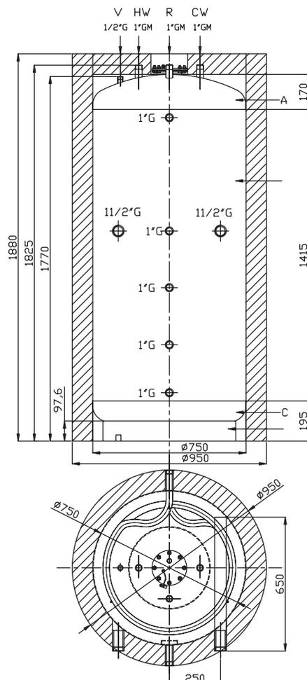
kein Standard-Einschraubheizkörper verwendbar!
