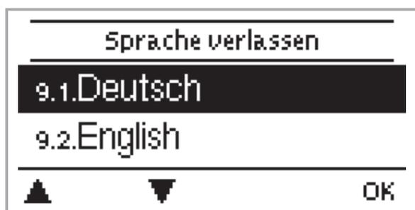
Über das Menü „9. - Sprache“ kann die Sprache der Menüführung gewählt werden. Bei der ersten Inbetriebnahme erfolgt die Abfrage automatisch.
