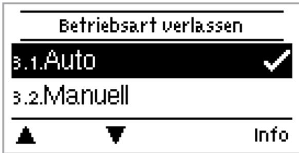
Im Menü "3. Betriebsarten" kann der Regler neben dem Automatikbetrieb auch ausgeschaltet oder in einen manuellen Betriebsmodus versetzt werden.
