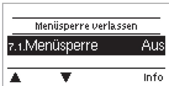
Durch das Menü „7. - Menüsperre“ kann der Regler dagegen gesichert werden, dass die eingestellten Werte unbeabsichtigt verstellt werden.
