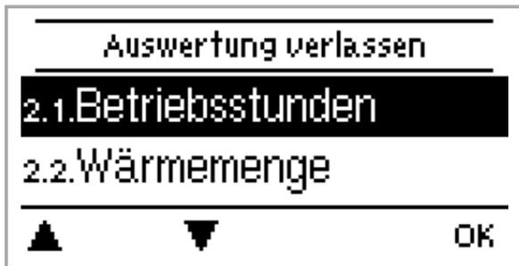
Das Menü "2. Auswertungen" dient zur Funktionskontrolle und Langzeitüberwachung der Anlage.
