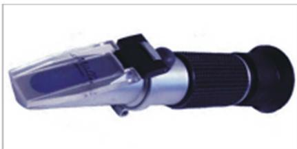
(Fig. 13: Refraktometer (Beispiel))
