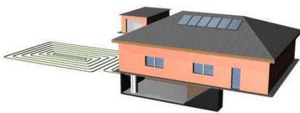
(Fig. 27: Erdkollektor als Flächenabsorber)
