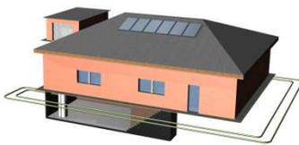
(Fig. 26: Erdkollektor längs im Graben)
