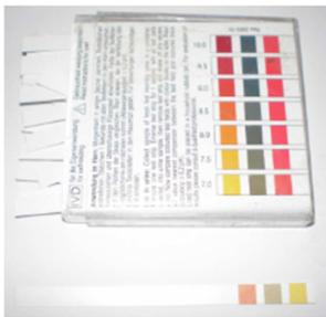
(Fig. 16: pH-Teststreifen)
