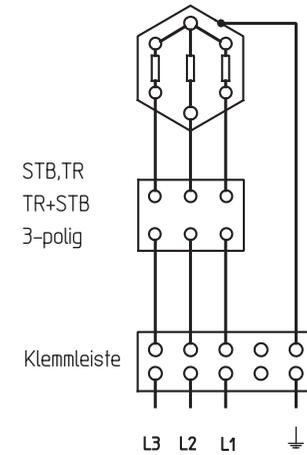
Einschraubheizkörper mit 3 Heizkreisen
