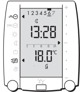
2. Sobald der Aussentemperaturwert die eingestellte **Heizgrenze Absenkbetrieb** ☺ (Einsteller 3:05) überschreitet, schaltet der Regler im Absenkbetrieb auf **AUS/Sommerbetrieb** ☺. Weitere Funktionen wie oben beschrieben.
