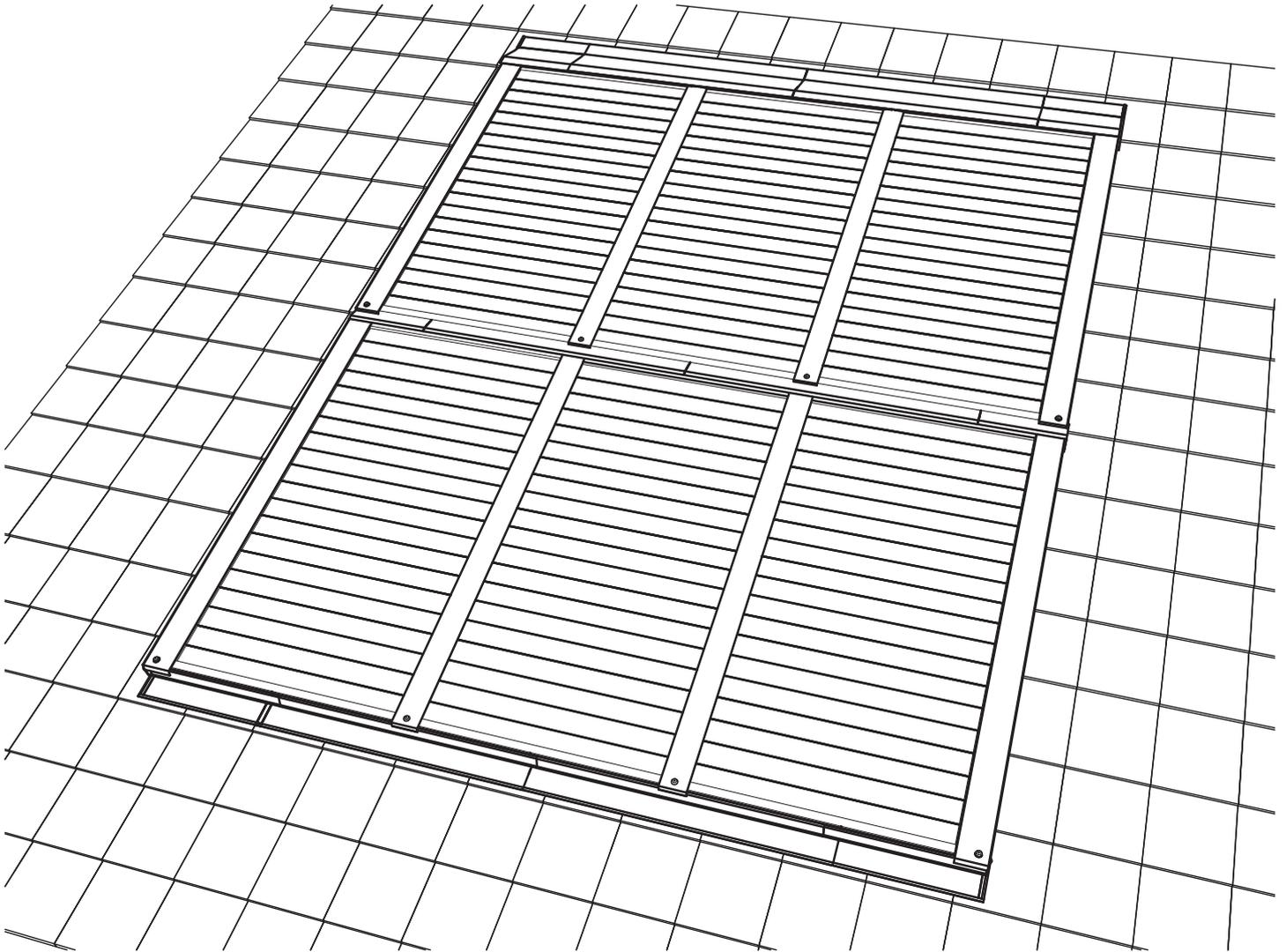
**Einblechung für Dächer ab 27° Neigung! System für Dächer kleiner 27° Neigung a. Anfrage.
