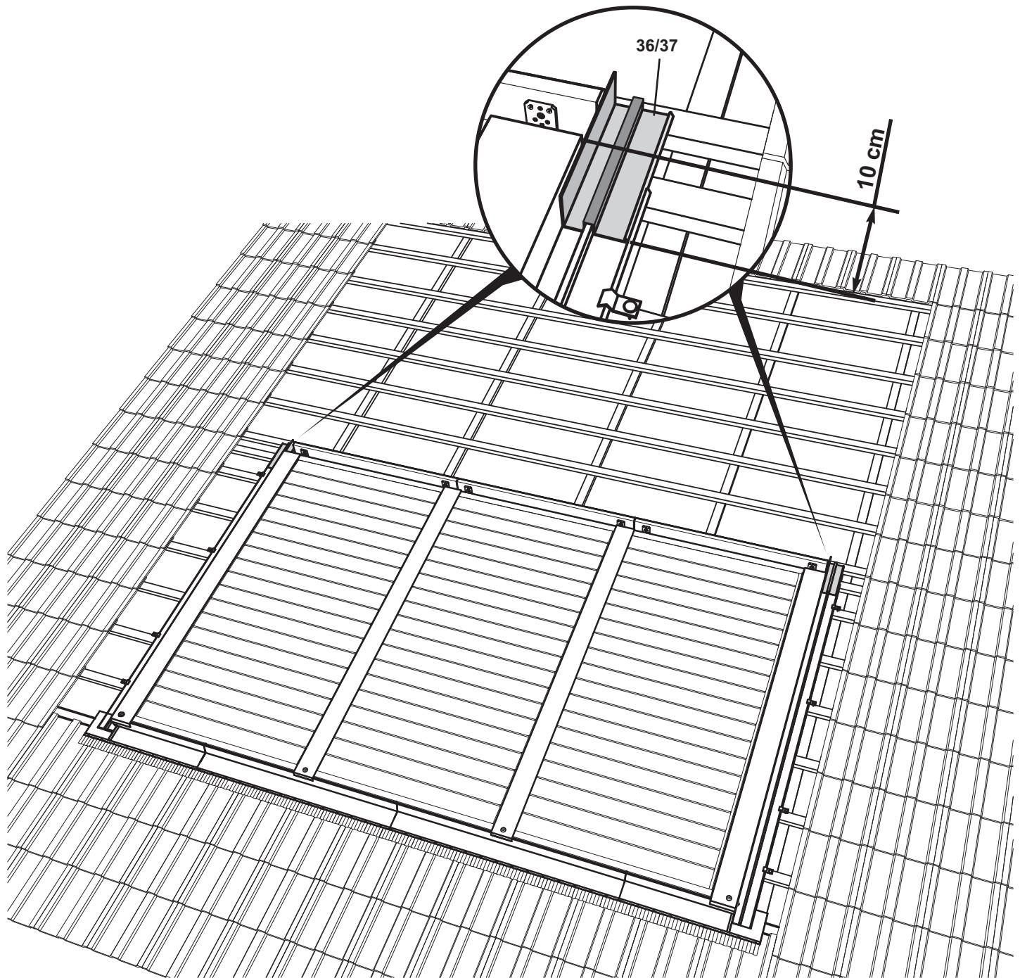
**D Linkes seitliches Horizontal-Abdeckabdeckblech (39) montieren**
