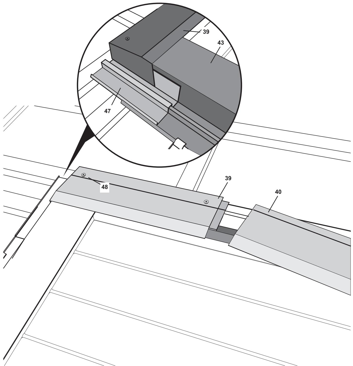
**D Restliche Horizontal-Zwischenabdeckbleche(40/41/42) montieren**
